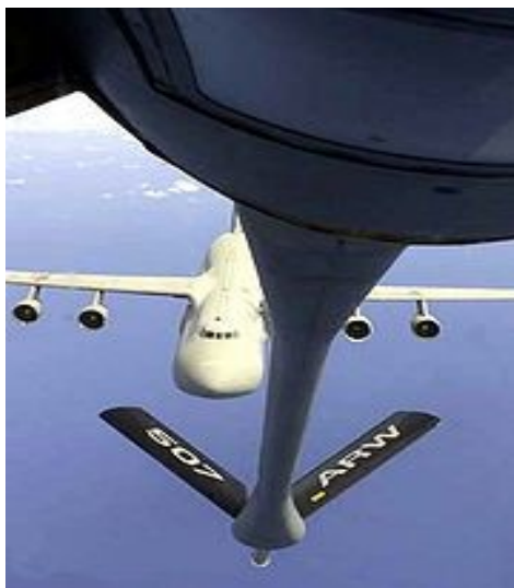
Velivolo KC-135 con sonda rigida telescopica per rifornimento aereo
